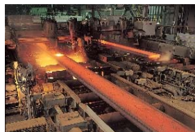
連続鋳造設備
