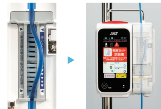
チューブが浮いたり曲がって装着された場合、
